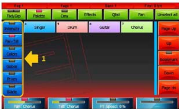
VENTANA DE LA PALETA PAN/TILT. SE RESALTÓ CON UN "1" LA TECLA DE SELECCIÓN DE LA FAMILIA DE PALETAS
